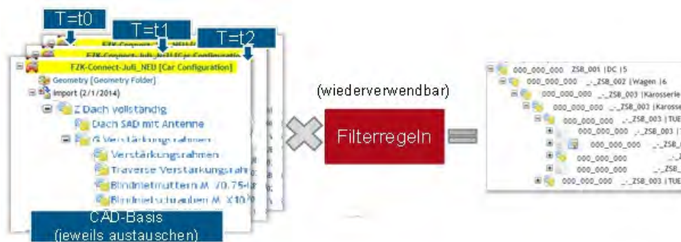
Bild 4: Mechanismus zur Definition relevanter CAD - Geometrie
